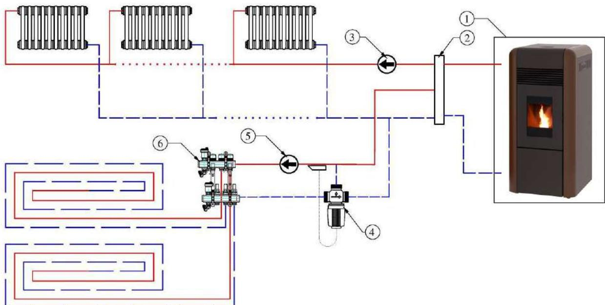
Oznake: 1-Kotao na pelet,2-Hidraulična skretnica,3-Cirkulaciona pumpa,4-Trokraki ventil sa nalegajućim termostatom,5-Cirkulaciona pumpa,6-Razdelnici podnog grejanja
