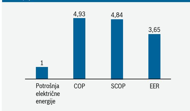
\*COP važi na temperaturi vazduha od 7°C i temperaturi vode od 35°C na polazu za model Compress 6000 AW 7. EER za model Compress 6000 AW 5 važi na temperaturi vazduha od 35°C i temperaturi polazne vode od 18°C.
