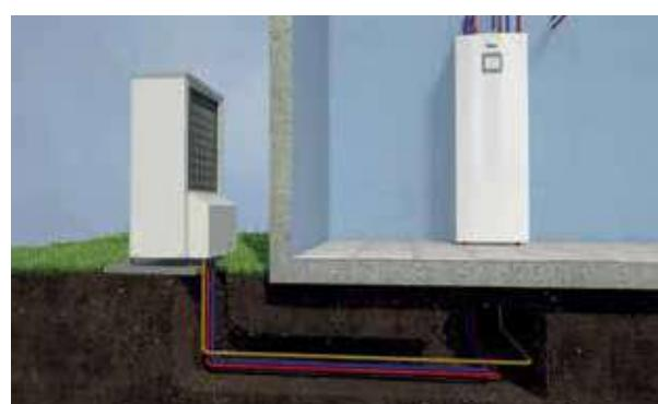
Monoenergetski režim rada sa unutrašnjim „toranj“ modulima AW M ili AW M S. Oba karakteriše integrirani rezervoar za sanitarnu topalu vodu sa veoma niskim toplotnim gubicima i izrađen je od najkvalitetnijeg nerđajućeg čelika. Modul AW M S je predviđen za povezivanje na solarni sistem.
